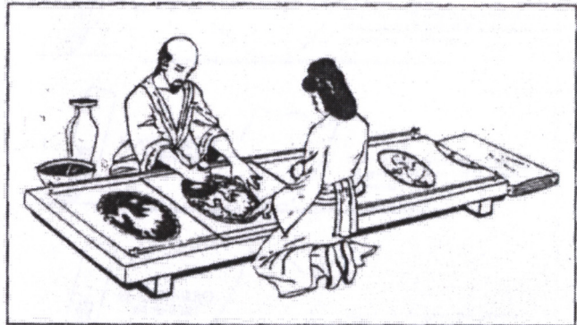
2.2 Antico sistema di stampaggio con stampino giapponese. Il tampone imbevuto d'inchiostro, premuto, tinge il tessuto sottostante.
